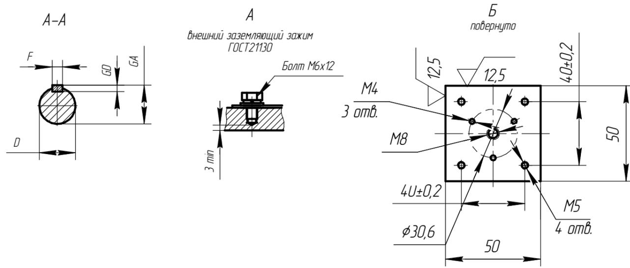
Чертеж Г.11 Электродвигатель асинхронный взрывозащищенный АИМУ 100 с площадкой датчика вибрации.
