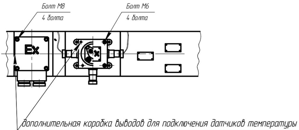
Чертеж Е.9 Электродвигатель взрывозащищенный 2АИМУР 315.
