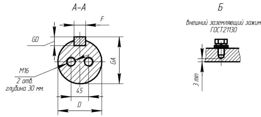
Чертеж Д.30 Электродвигатель асинхронный взрывозащищенный АИМУР 280
