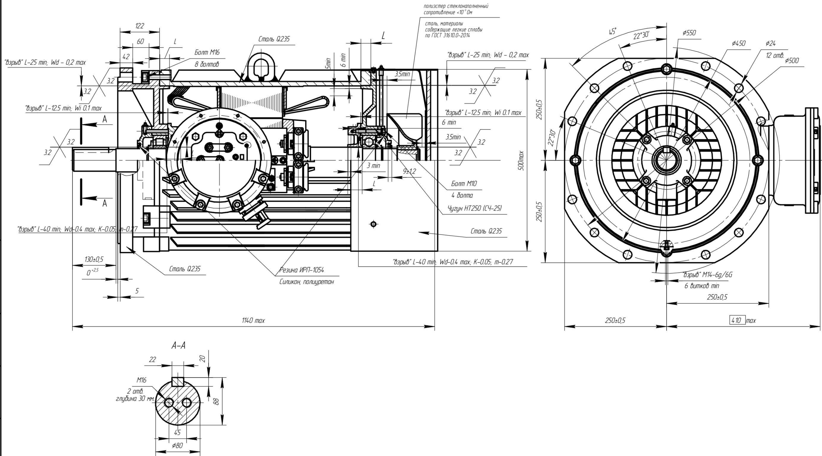
Чертеж Д.37 Электродвигатель взрывозащищенный АИМЧР 250LB4 (ЗЭДКОФ 250LB4 110/1500)
