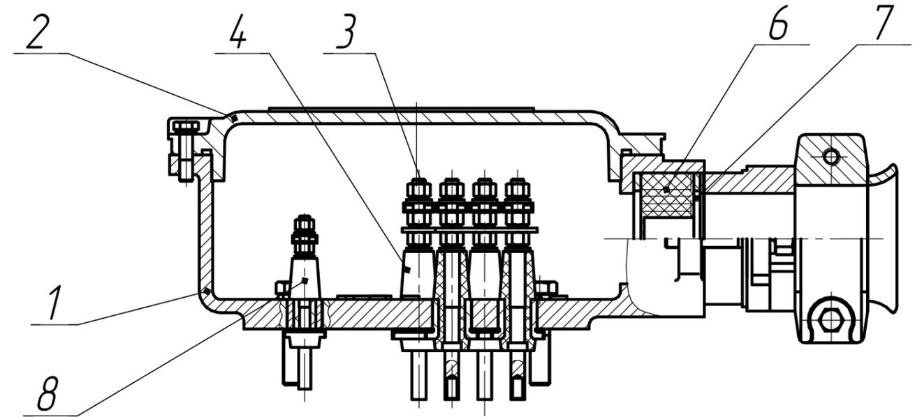
Рисунок В.4 Конструктивная схема вводного устройства двигателя АИМУРВ
