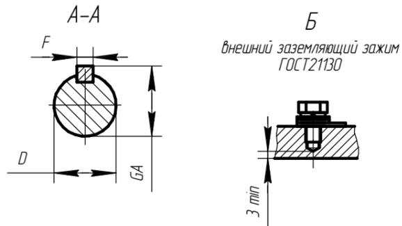
Чертеж Д.11 Электродвигатель взрывозащищенный АИМУР 112
