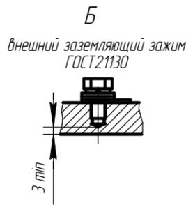
Чертеж Г.18 Электродвигатель асинхронный взрывозащищенный АИМУ 160
