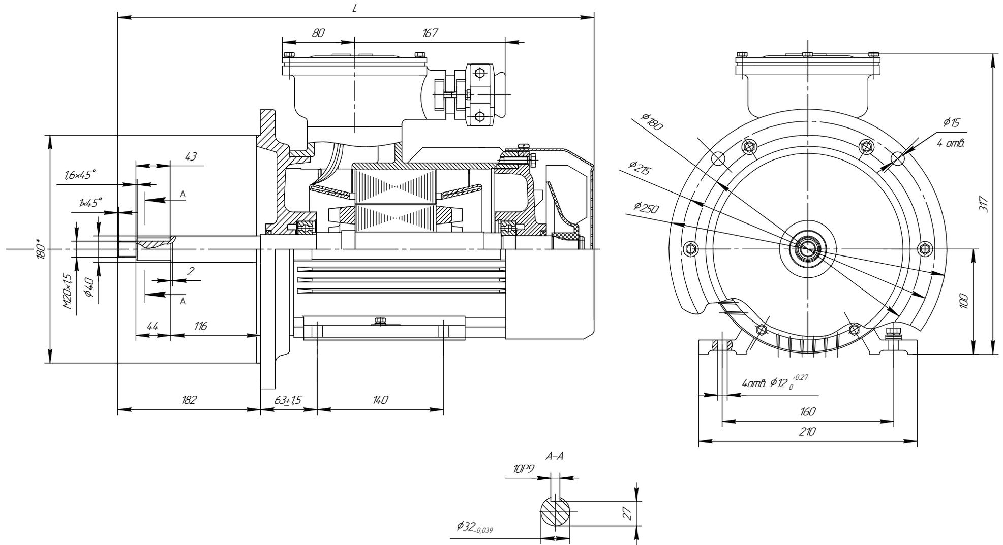
Рисунок Б.3 (обязательное) Габаритные, установочные и присоединительные размеры двигателей АИМУ основного исполнения.
