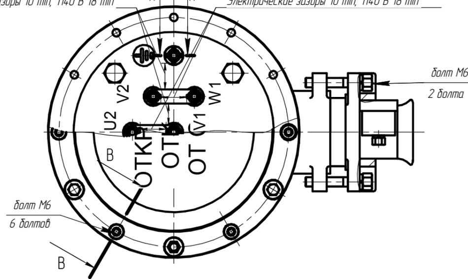
Чертеж 3.22 Вводное устройство М6 электродвигателя АИМЧР160-180 (тип 3)
