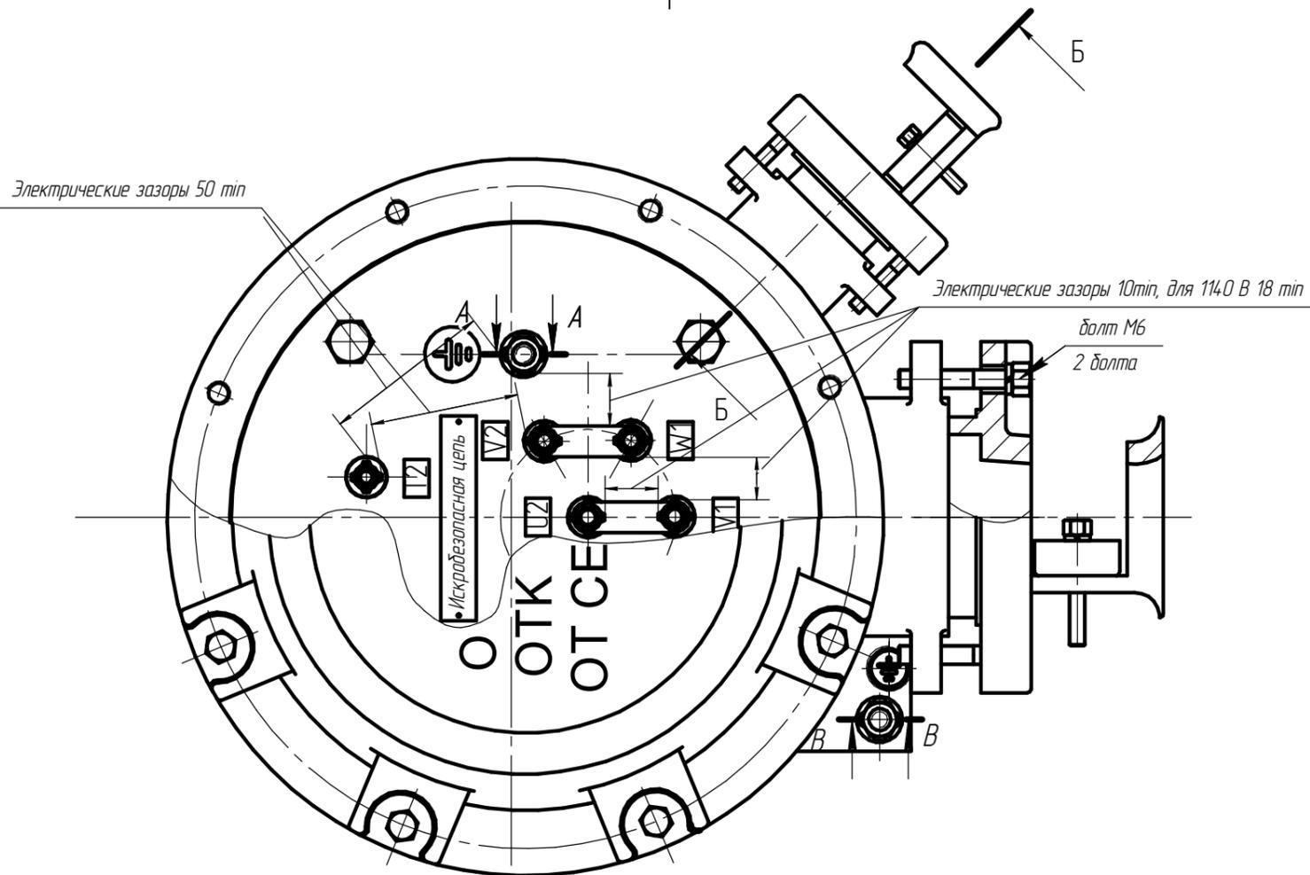
Чертеж 3.20 Вводное устройство М6 электродвигателя АИМУР(В) 160-180 (тип 1)
