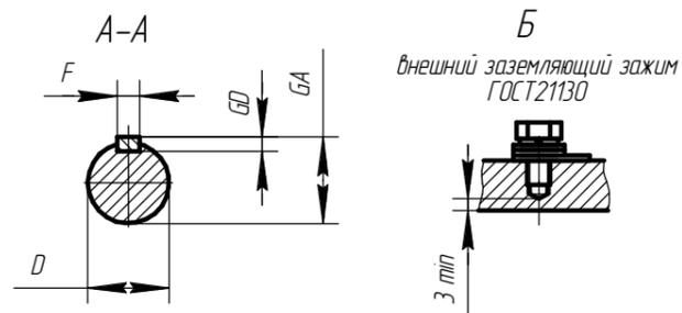
Чертеж Г.19 Электродвигатель асинхронный взрывозащищенный АИМУ 160
