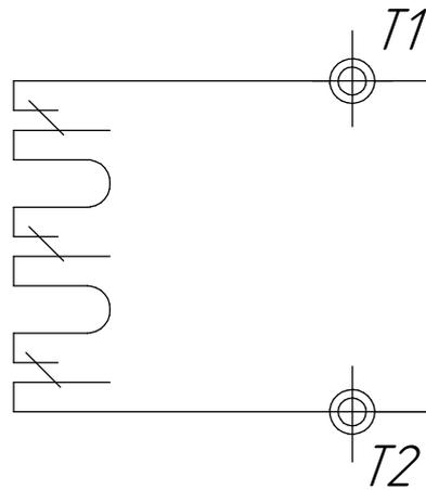
Рисунок К.2 Схема соединения термисторов типа РТС или биметаллических датчиков
