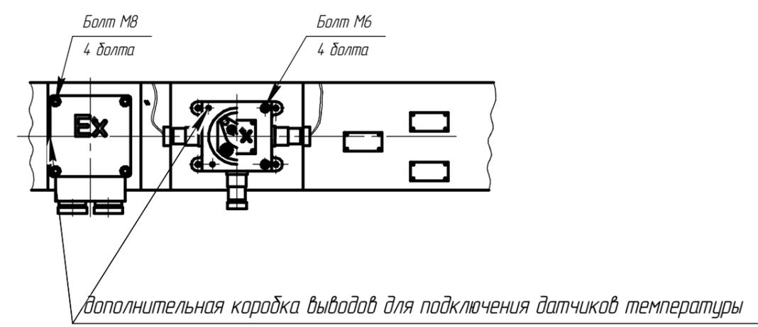
Чертеж E.10 Электродвигатель взрывозащищенный 2АИМУР 315.
