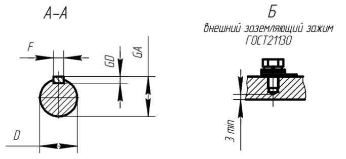
Чертеж Д.13.2 Электродвигатель взрывозащищенный АИМУР 112 (чугунная станина)
