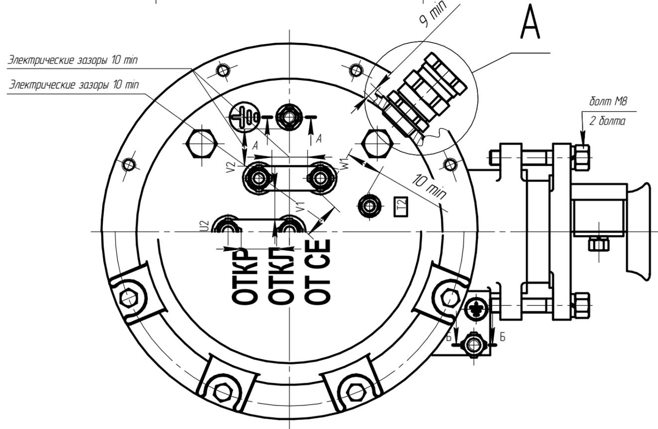
Чертеж 3.9 Вводное устройство М8 электродвигателя АИМУ 200-225.
