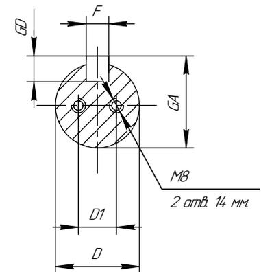
Рисунок Б.12 Габаритные, установочные и присоединительные размеры двигателей АИМУР 160-180 основного исполнения.
