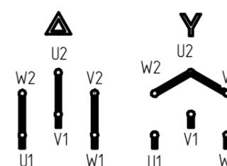
Чертеж 3.6 Вводное устройство М6 электродвигателя АИМУ 132-180
