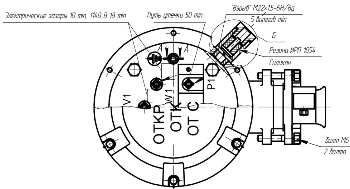
Чертеж 3.24 Вводное устройство М6 электродвигателя АИМЧР 160-180 (тип 5)
