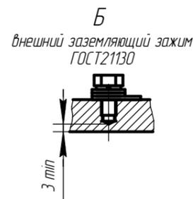
Чертеж Д.17 Электродвигатель асинхронный взрывозащищенный АИМУР 132
