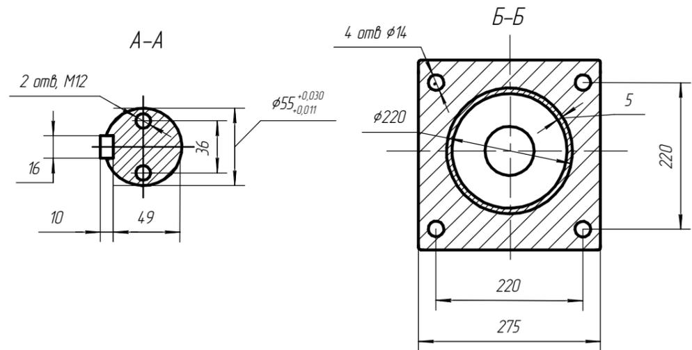
Чертеж Ж.5 Электродвигатель взрывозащищенный АИМУРВ 225 М2
