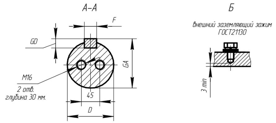
Чертеж Д.31 Электродвигатель асинхронный взрывозащищенный АИМЧР 280.
