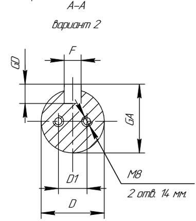
Рисунок Б.9 Габаритные, установочные и присоединительные размеры двигателей АИМУР 63-180 основного исполнения.
