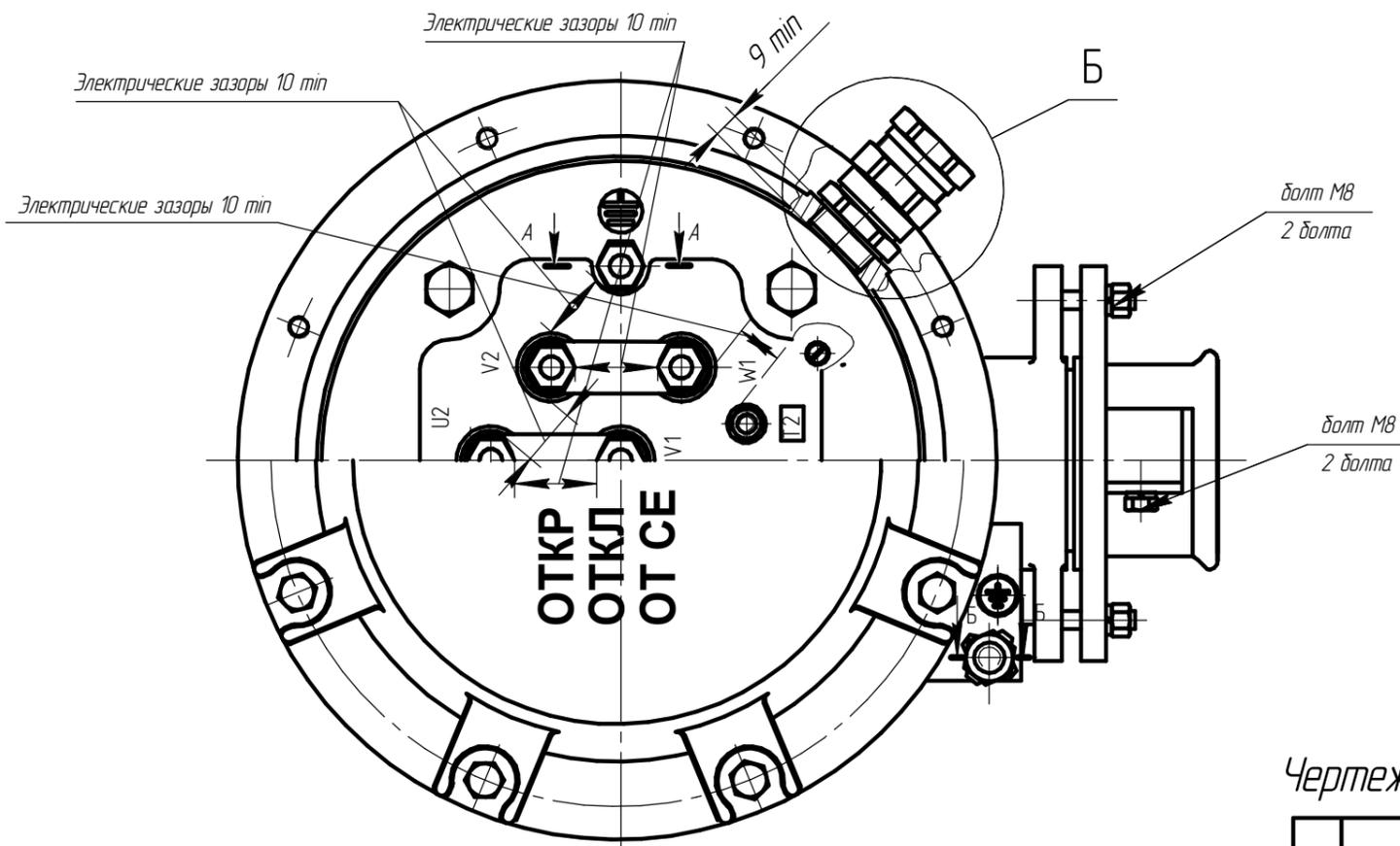
Чертеж 3.11 Вводное устройство М10 электродвигателя АИМУ 250-280
