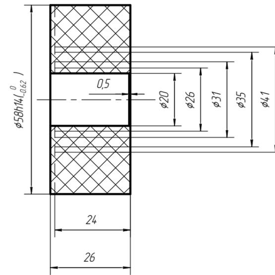
Чертеж 3.23 Вводное устройство М6 электродвигателя АИМЧР 160-180 (тип 4)
