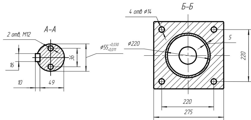
Чертеж Ж.7 Электродвигатель взрывозащищенный АИМУРВ 250 S2
