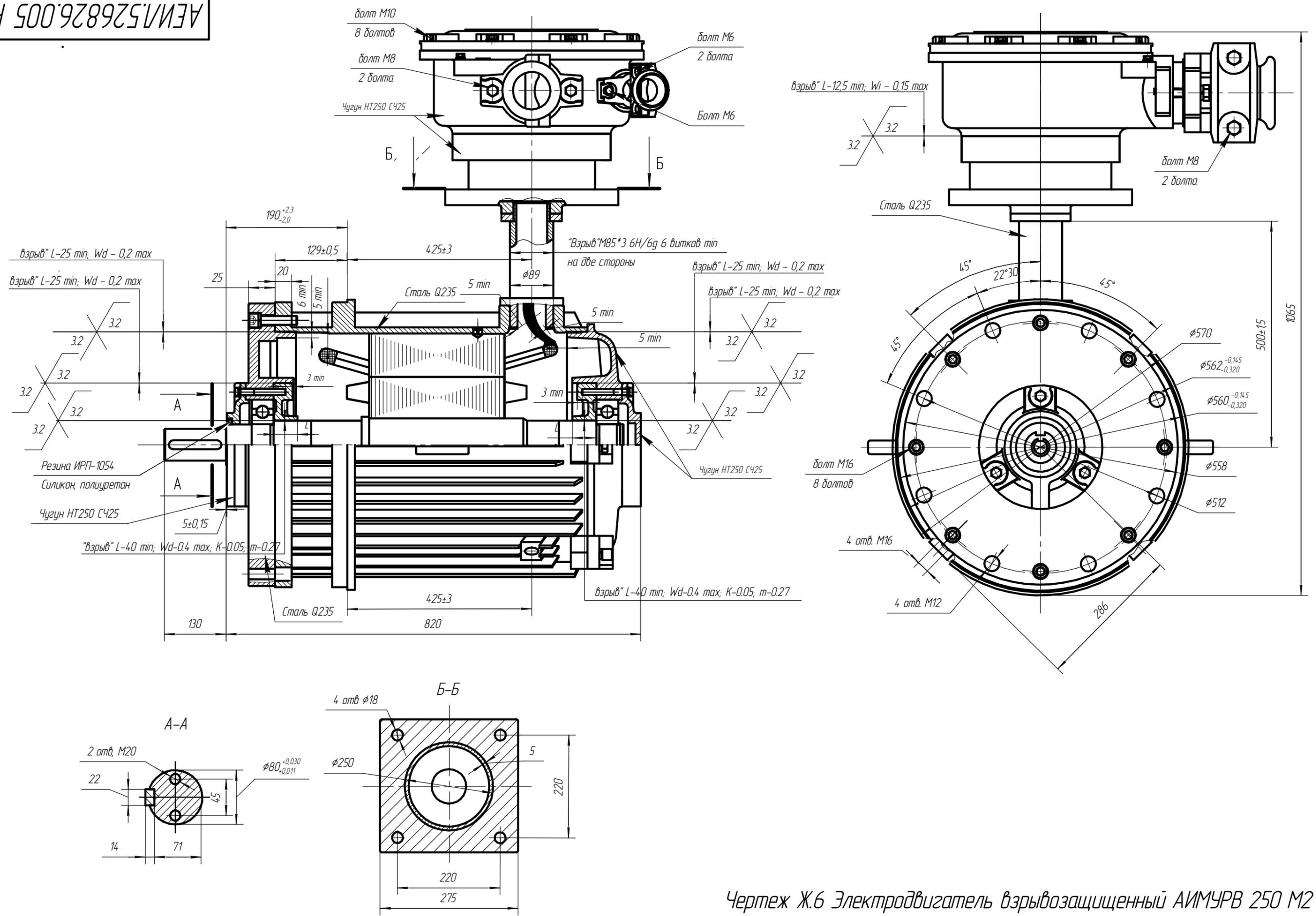
Чертеж Ж.6 Электродвигатель взрывозащищенный АИМУРВ 250 М2
