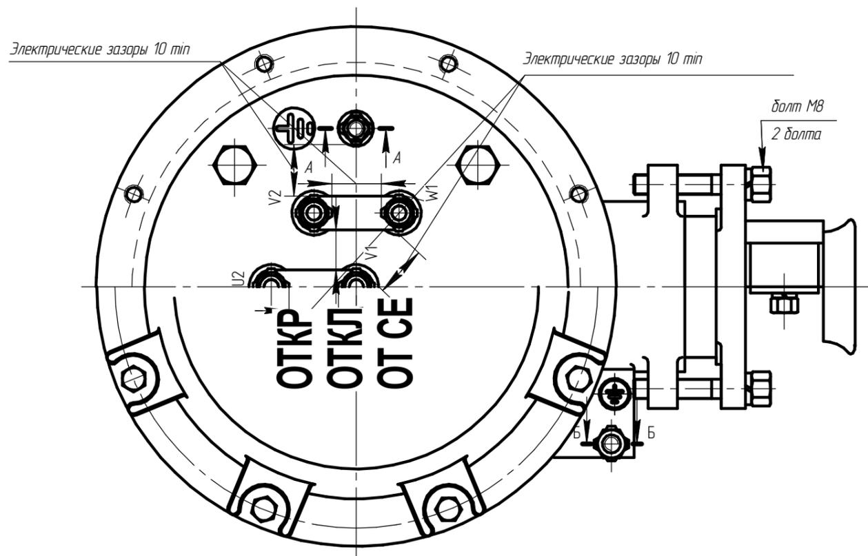
Чертеж 3.7 Вводное устройство М8 электродвигателя АИМУ 200-225.
