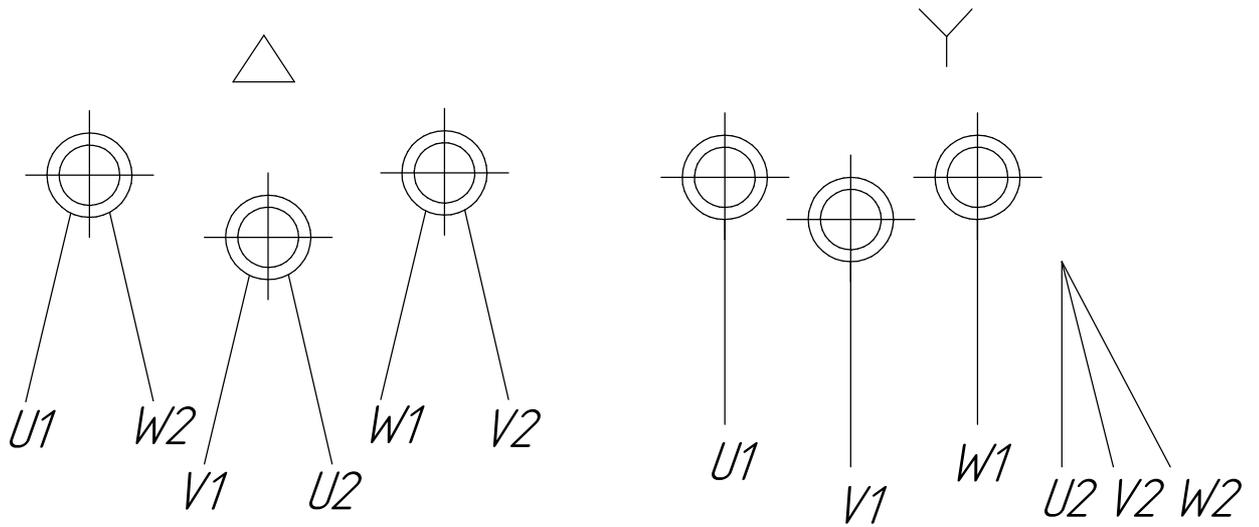
Рисунок К.1 Схема соединения обмоток статора
