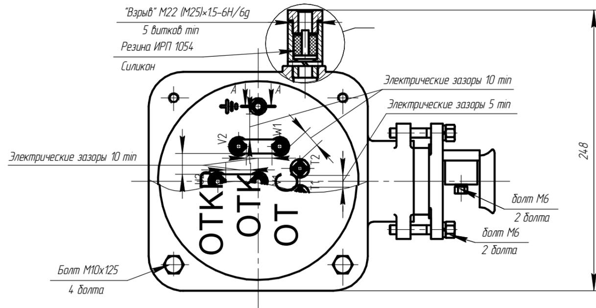
Чертеж 3.5 Вводное устройство М6 электродвигателя АИМУ 132-180
