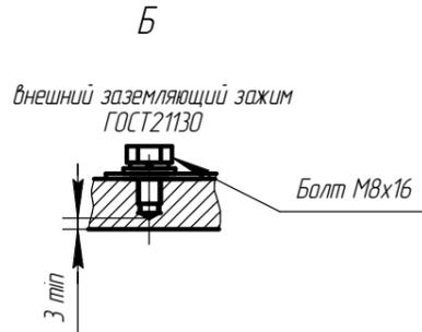
Чертеж Г.7 Электродвигатель асинхронный взрывозащищенный АИМУ 90
