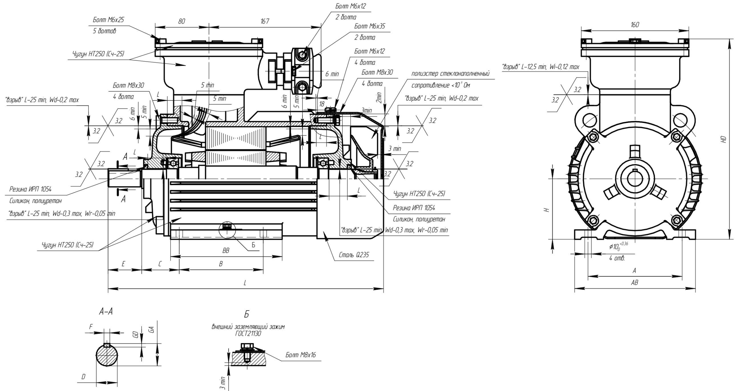
Чертеж Д.7 Электродвигатель асинхронный взрывозащищенный АИМУР 90
