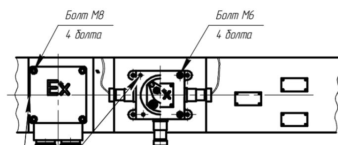
дополнительная коробка выводов для подключения датчиков температуры
