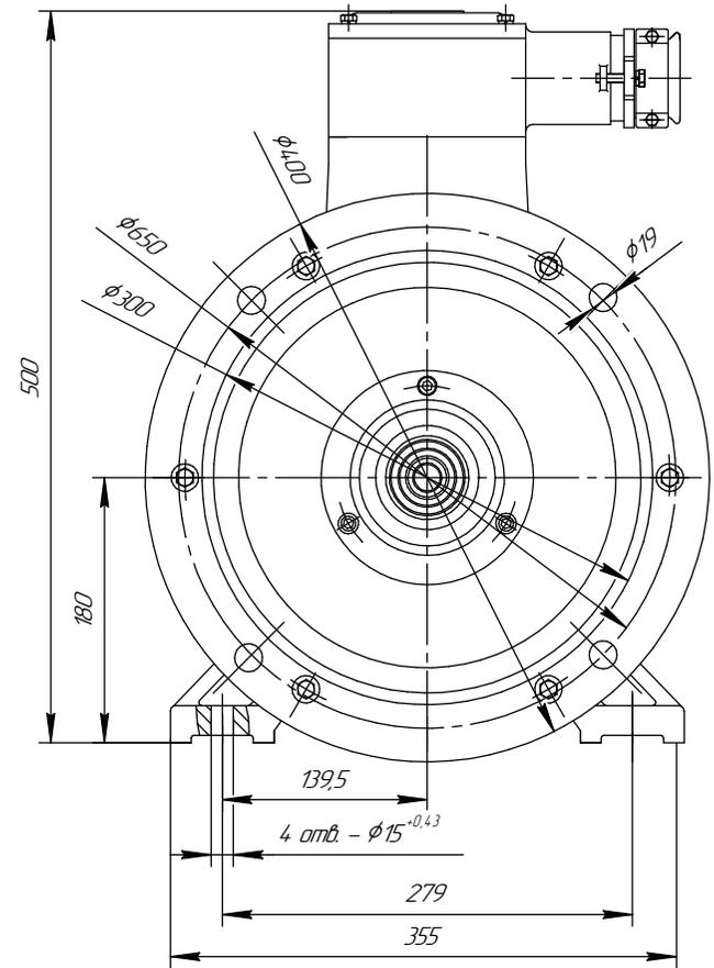
Рисунок Б.8 (обязательное) Габаритные, установочные и присоединительные размеры двигателей АИМУ основного исполнения.
