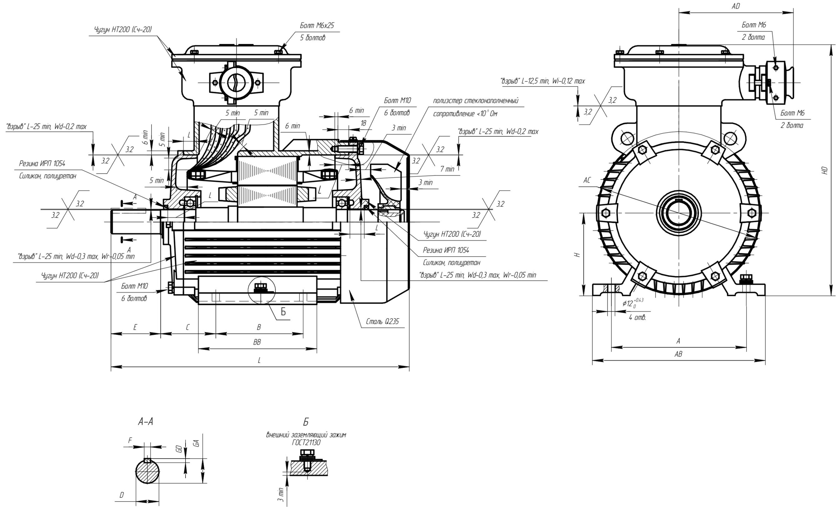
Чертеж Г.14 Электродвигатель асинхронный взрывозащищенный АИМУ 112
