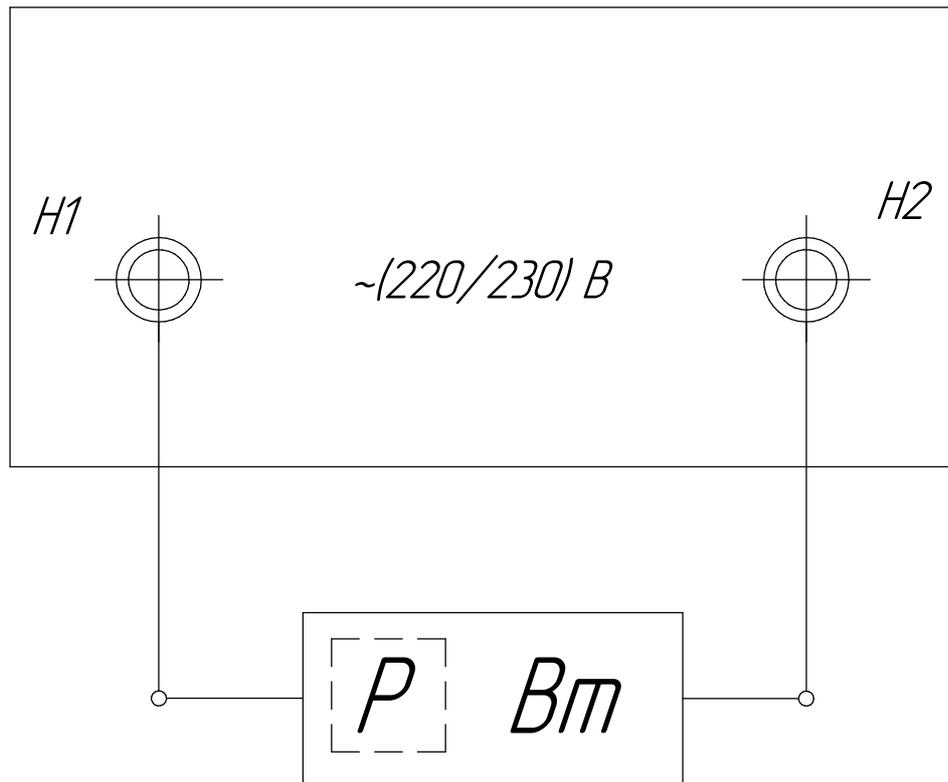
Рисунок М.1 Схема подключения антиконденсатного
