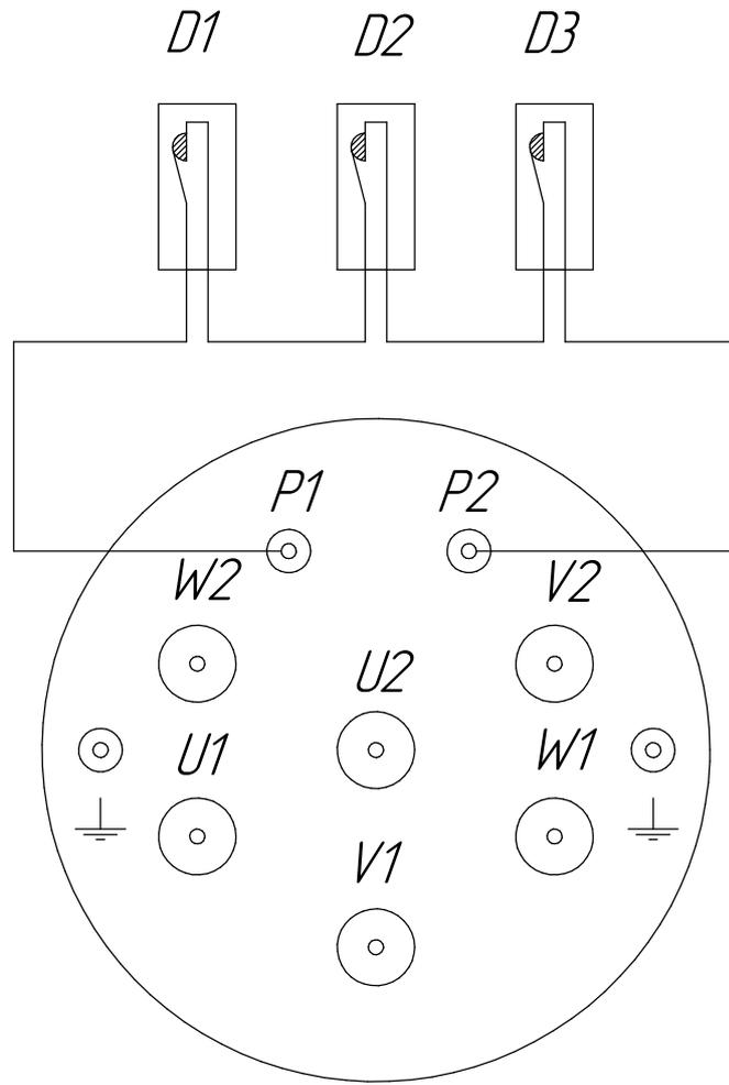
*D1...D3 – биметаллические датчики
