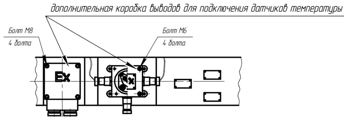
Чертеж Е.15 Электродвигатель взрывозащищенный 2АИМУР 355.
