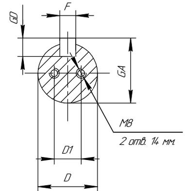
Рисунок Б.10 Габаритные, установочные и присоединительные размеры двигателей АИМУР 63-180 основного исполнения.
