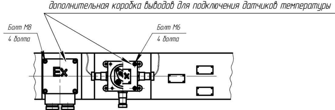
Чертеж Е.12 Электродвигатель взрывозащищенный 2АИМУР 355.
