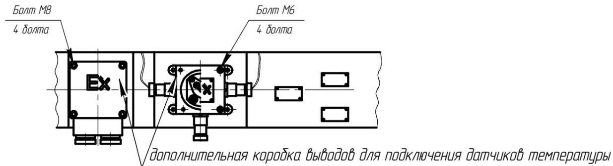
Чертеж E.11 Электродвигатель взрывозащищенный 2АИМУР 355.
