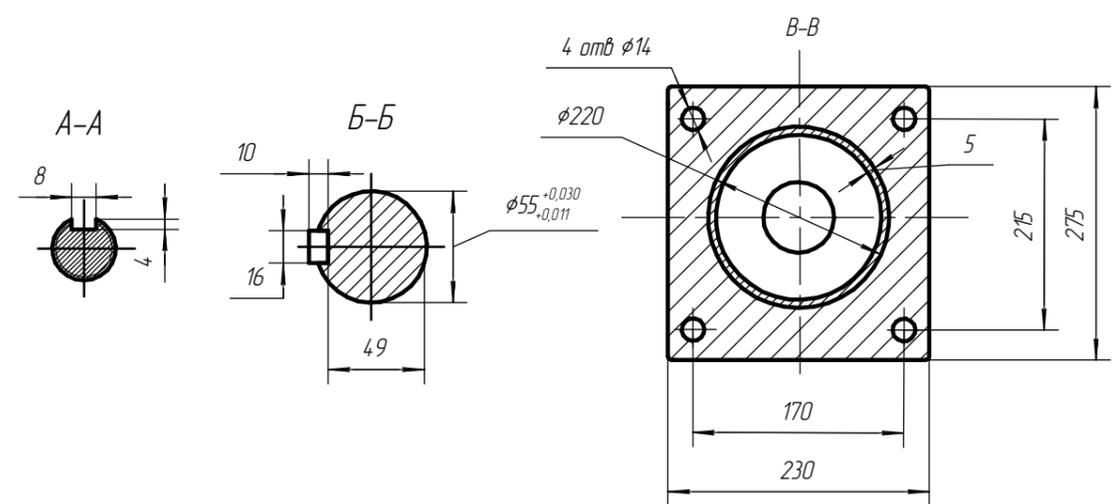
Чертеж Ж.4 Электродвигатель взрывозащищенный АИМЧРВ 200 L2
