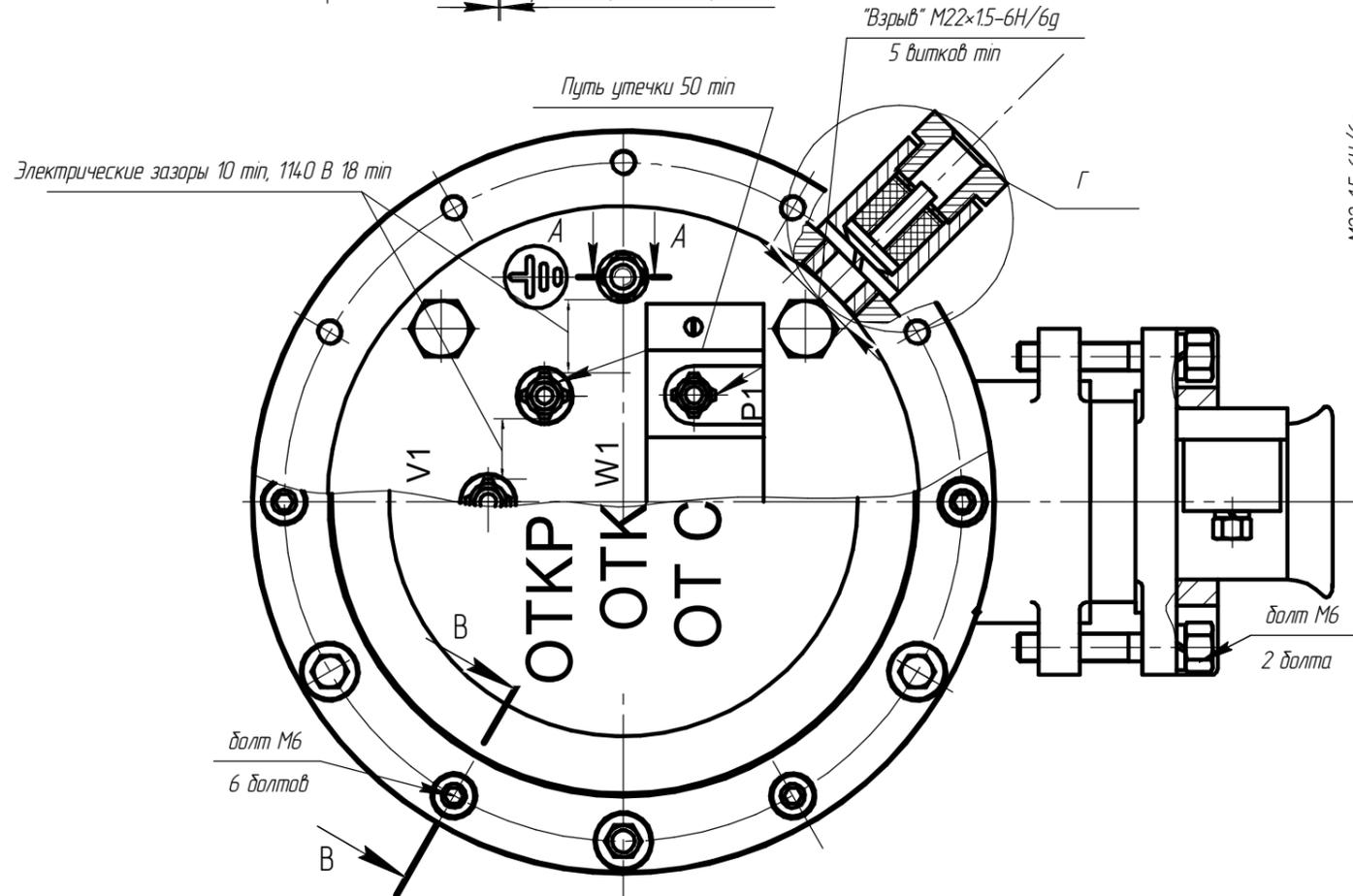
Чертеж 3.21 (обязательное). Вводное устройство М6 электродвигателя АИМУР160-180 (тип 2) Коробка выводов для напряжения 380/660 В, 660/1140 В
