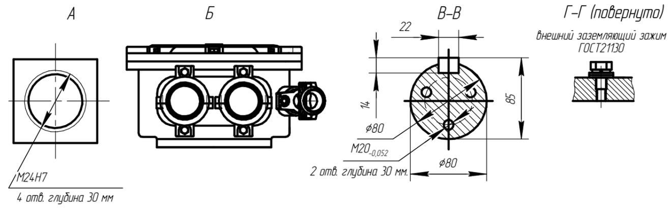
Чертеж Ж.8 Электродвигатель взрывозащищенный АИМУРВ 280
