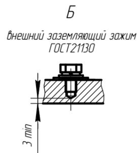
Чертеж Д.24 Электродвигатель асинхронный взрывозащищенный АИМУР 225.
