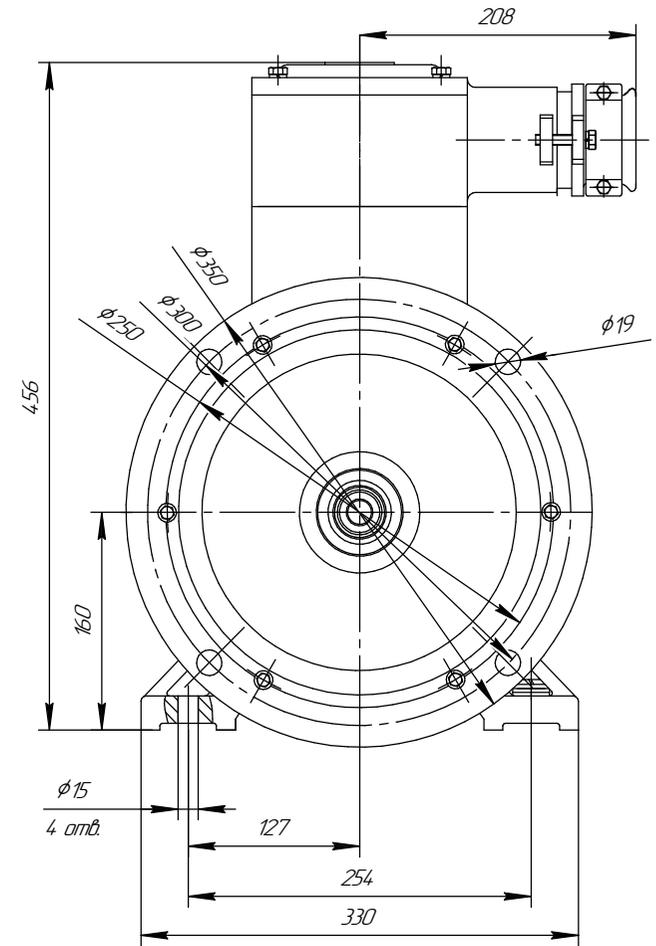
Рисунок Б.5 (обязательное) Габаритные, установочные и присоединительные размеры двигателей АИМУ основного исполнения.
