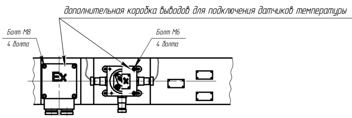
Чертеж Е.13 Электродвигатель взрывозащищенный 2АИМУР 355.
