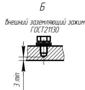
Чертеж Д.19 Электродвигатель асинхронный взрывозащищенный АИМУР160
