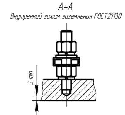
Чертеж 3.15 Вводное устройство M16 электродвигателя АИМУ 280-355.
