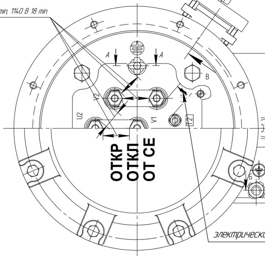
электрические зазоры 50 мм
