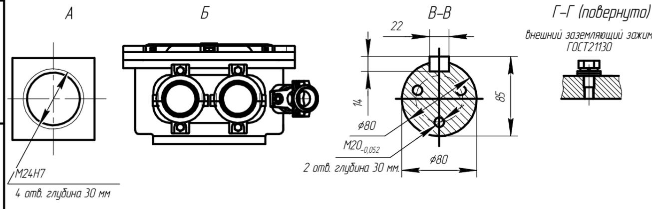
Чертеж Ж.7 Электродвигатель взрывозащищенный АИМУРВ 280
