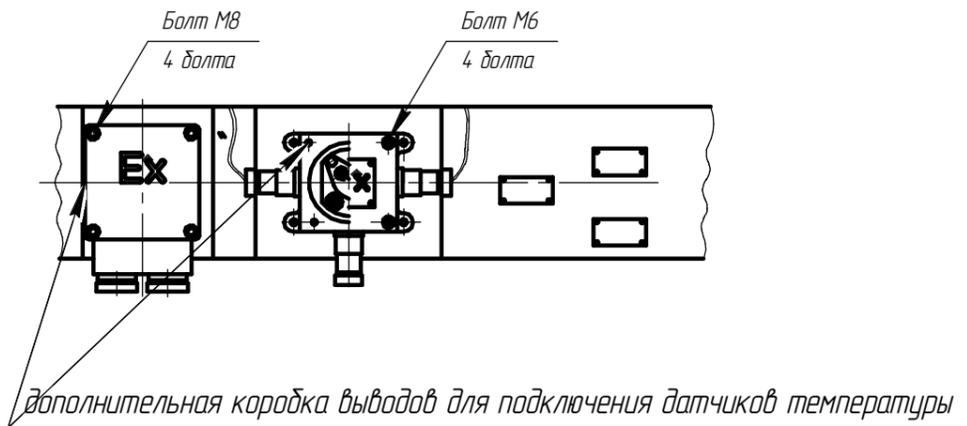
Чертеж Е.6 Электродвигатель взрывозащищенный 2АИМУР 315.
