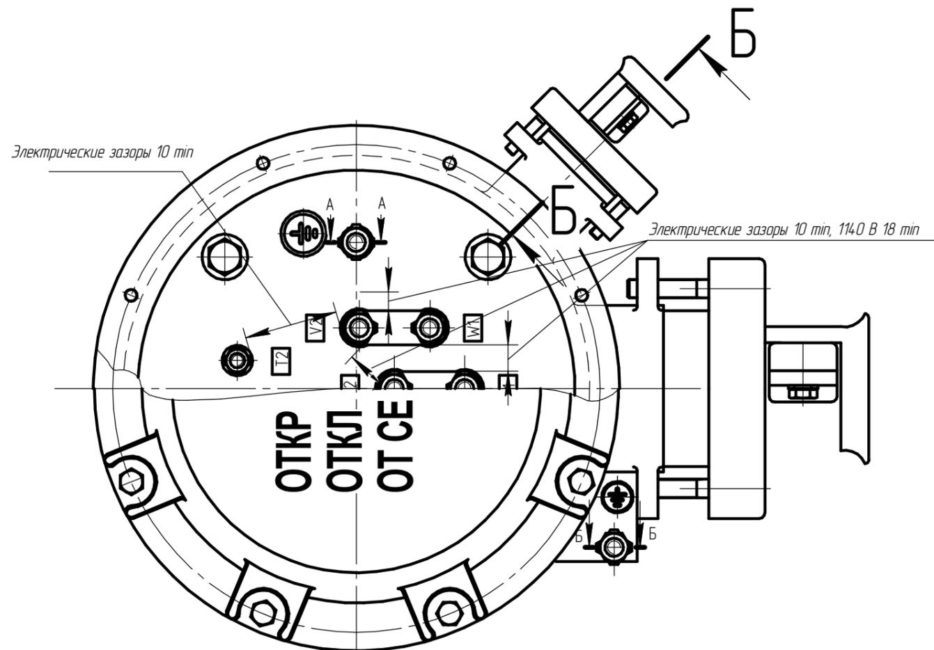
Чертеж 3.8 Вводное устройство М8 электродвигателя АИМУ 200-225.
