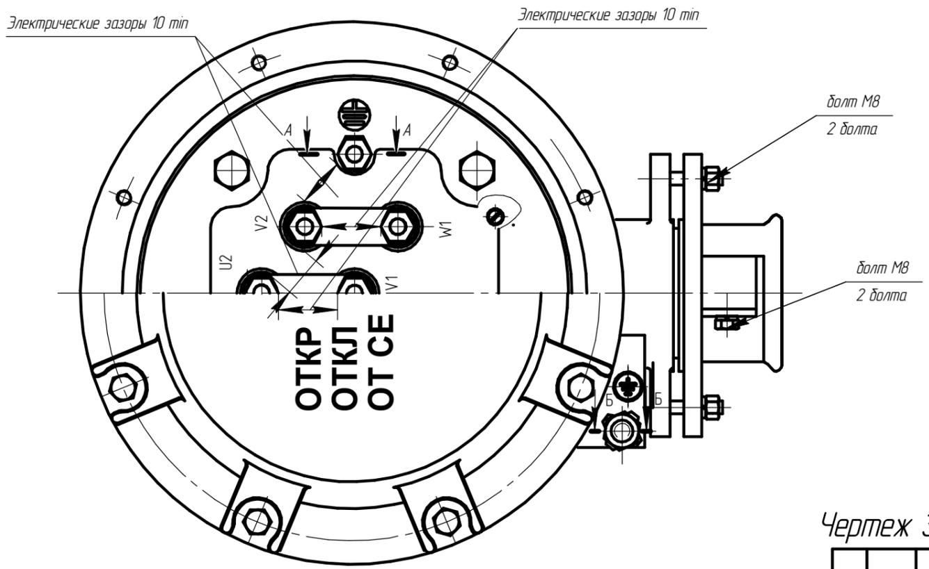
Чертеж 3.10 Вводное устройство М10 электродвигателя АИМУ 250-280
