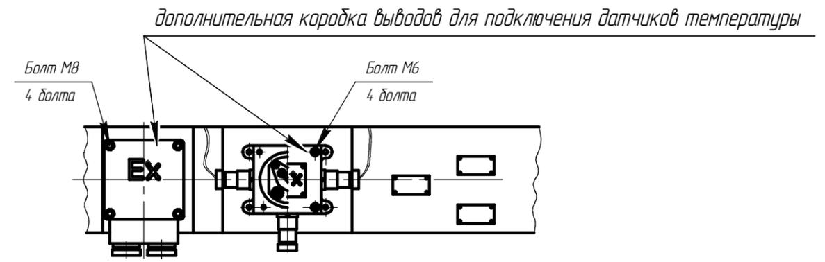
дополнительная коробка выводов для подключения датчиков температуры
