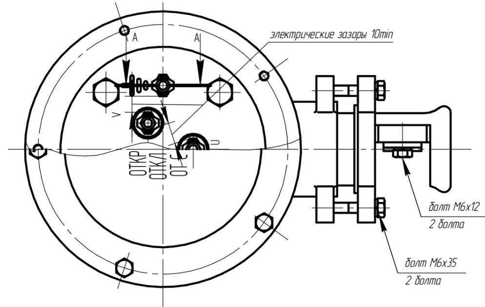
Чертеж 3.2 Вводное устройство М5 электродвигателя АИМУ 90-100
