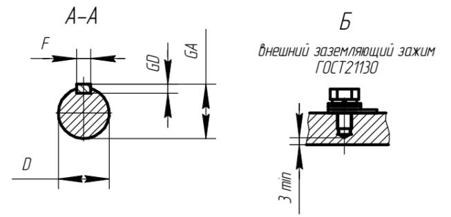
Чертеж Д.16 Электродвигатель асинхронный взрывозащищенный АИМУР 132
