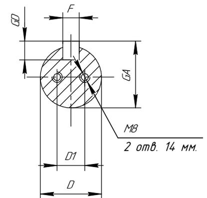
Рисунок Б.13 Габаритные, установочные и присоединительные размеры двигателей АИМУР 160-180 основного исполнения.
