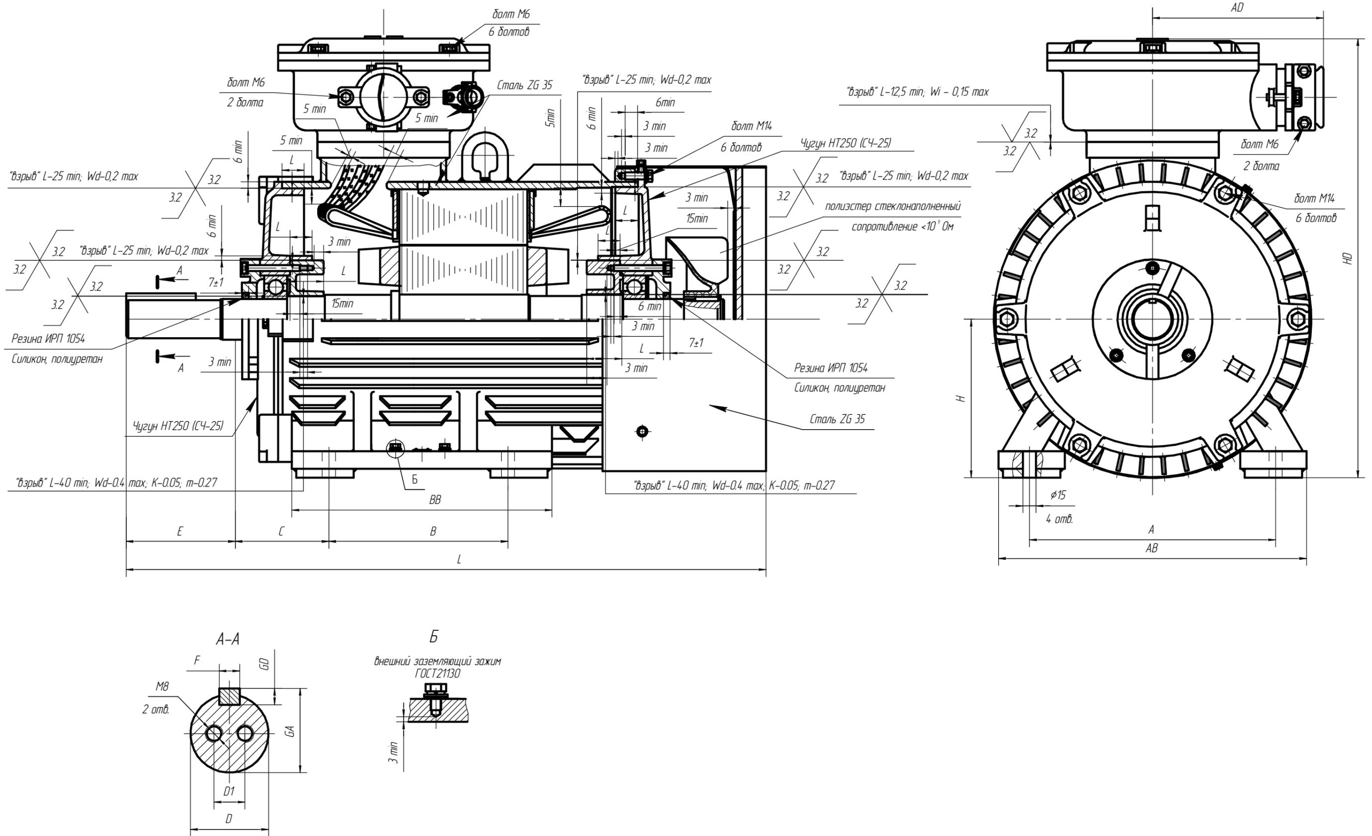
Рисунок Д.20 Электродвигатель асинхронный взрывозащищенный АИМУР180
