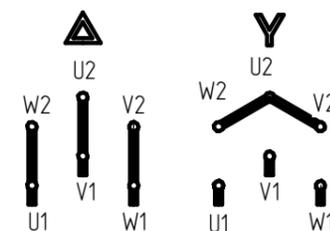
Чертеж 3.4 Вводное устройство М5\_1 электродвигателя АИМУ 112
