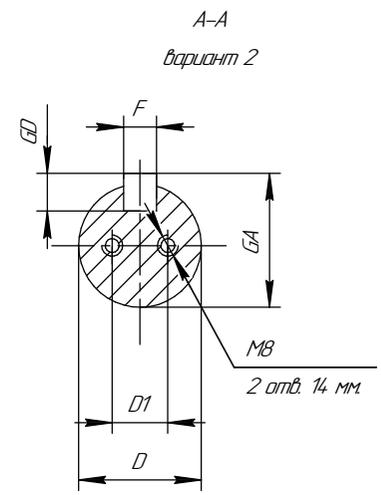
Рисунок Б.11 Габаритные, установочные и присоединительные размеры двигателей АИМУР 63-180 основного исполнения.
