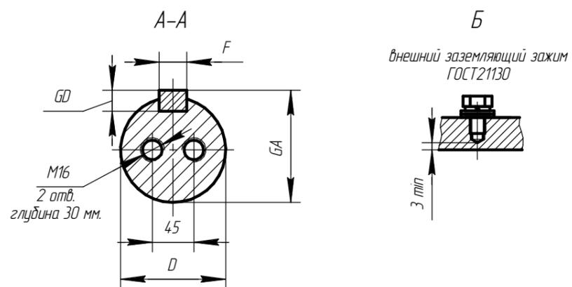
Чертеж Е.1 Электродвигатель взрывозащищенный 2АИМУР 280.
