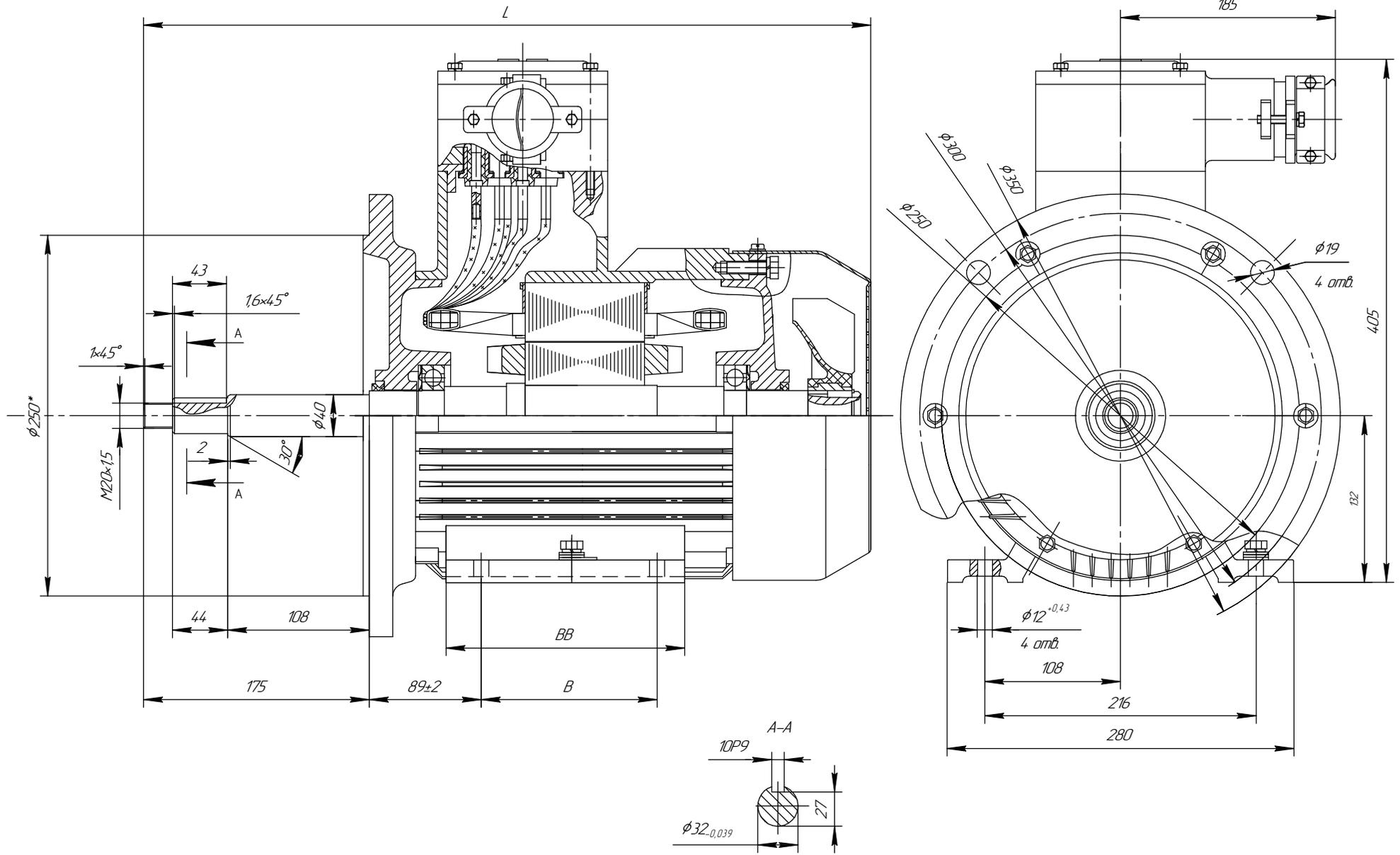
Рисунок Б.4 (обязательное) Габаритные, установочные и присоединительные размеры двигателей АИМУ основного исполнения.
