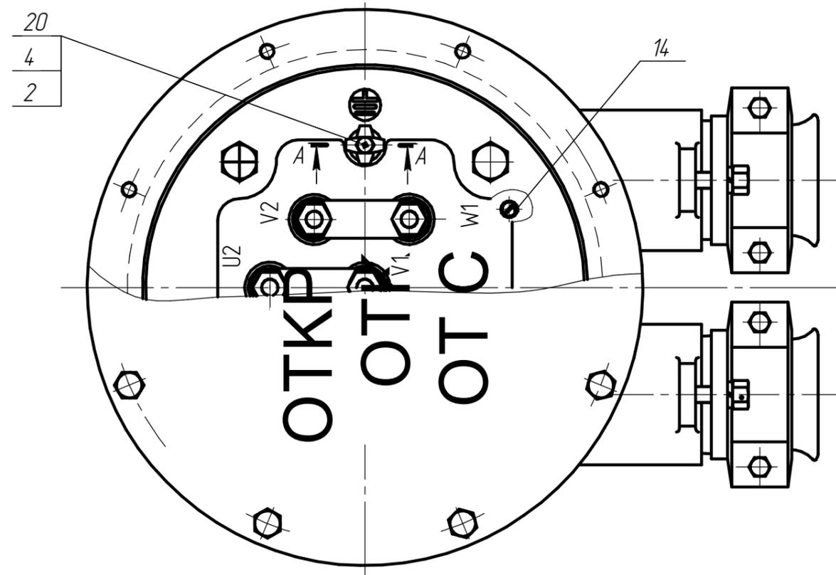
Рисунок В.2 Конструктивная схема коробки выводов электродвигателей (2)АИМУ(Р)
