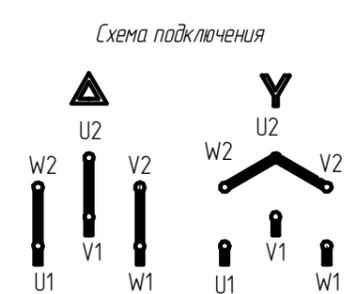
Чертеж 3.3 Вводное устройство М5\_1 электродвигателя АИМУ 112
