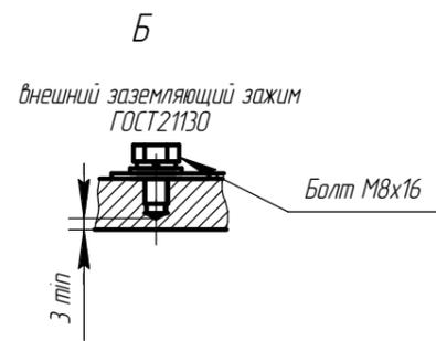
Чертеж Г.8 Электродвигатель асинхронный взрывозащищенный АИМУ 90
