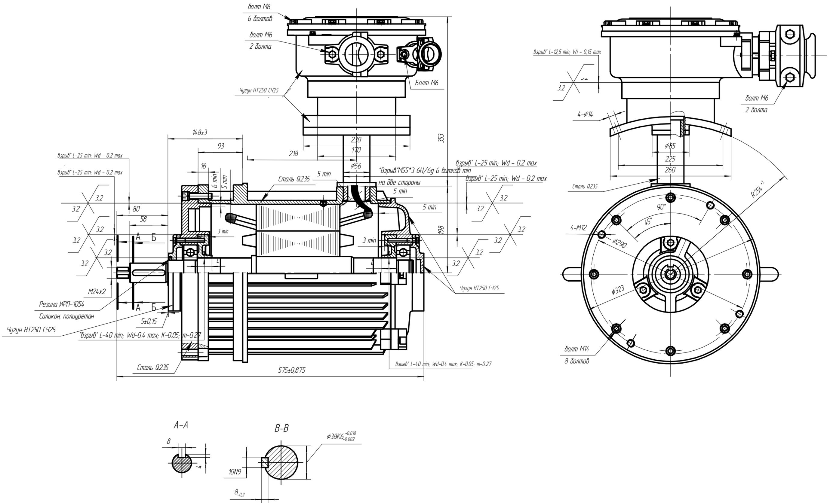
Чертеж Ж.1 Электродвигатель взрывозащищенный АИМУРВ 132 М2
