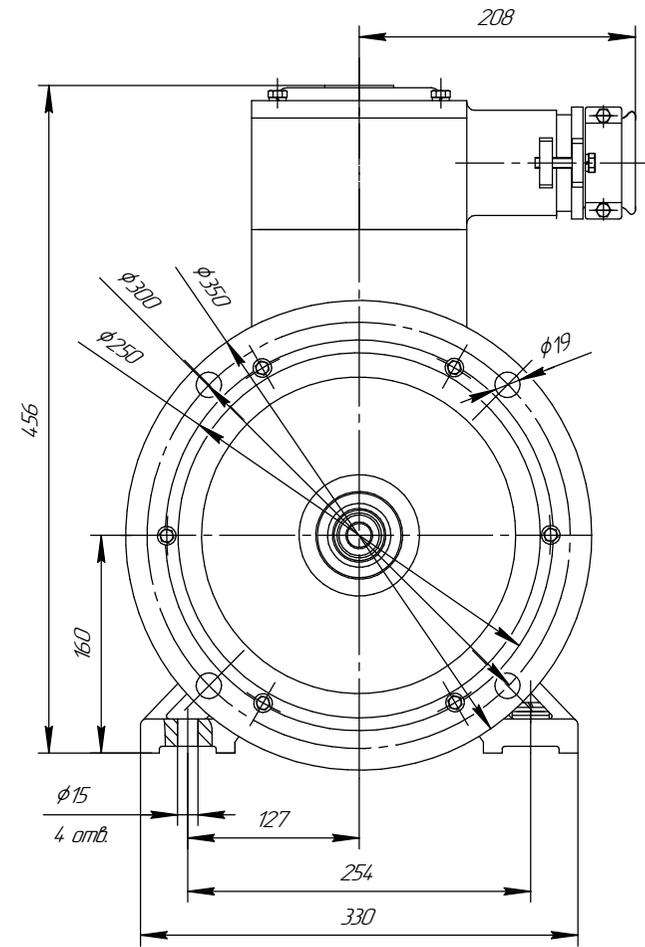
Рисунок Б.6 (обязательное) Габаритные, установочные и присоединительные размеры двигателей АИМУ основного исполнения.
