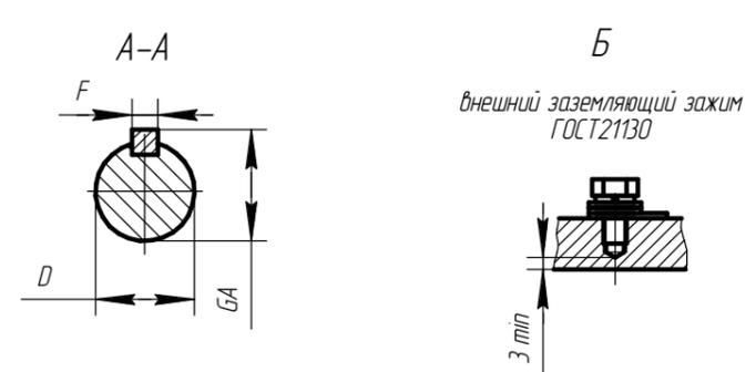
Чертеж Д.12 Электродвигатель взрывозащищенный АИМУР 112
