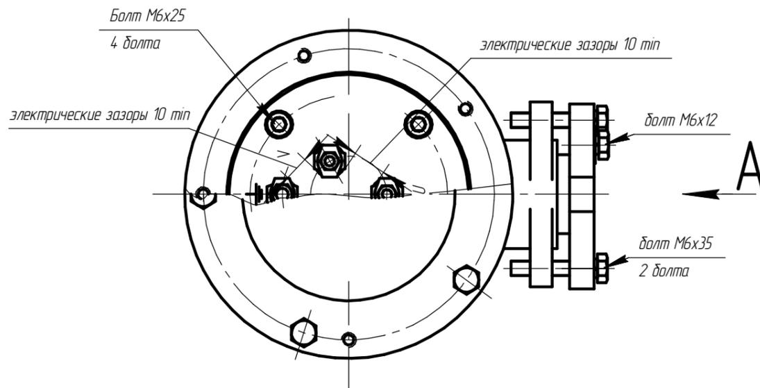
Чертеж 3.1 Вводное устройство М4 электродвигателя АИМУ 63-80
