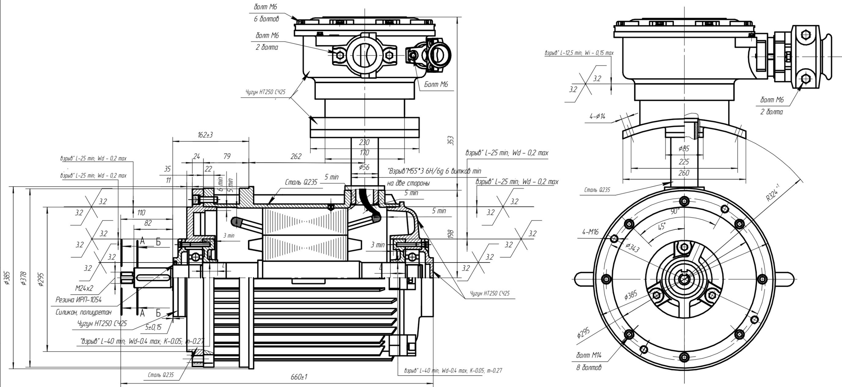
Чертеж Ж.2 Электродвигатель взрывозащищенный АИМЧРВ 160 М2
