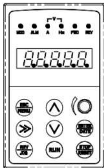
Рис. а Подача питания, отображение 8.8.8.8.8.
