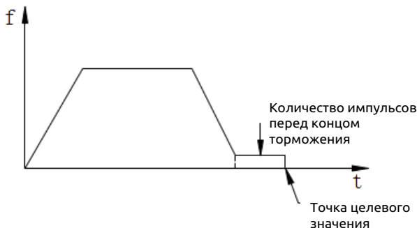
Рисунок 7-44. Остаточные импульсы после завершения торможения при позиционировании
