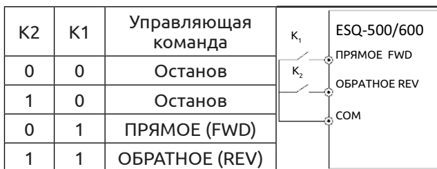
Рис. 7-17 Режим двухпроводного управления 2
