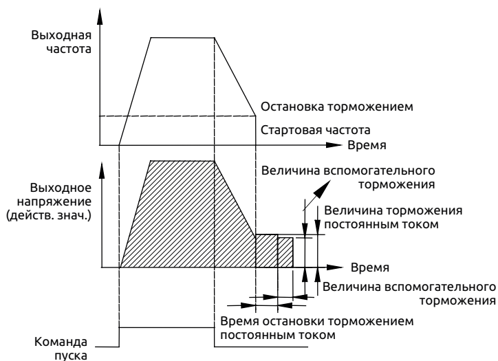
Рис. 7-5 Торможение до останова + торможение постоянным током
