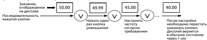
Рис. 5-9 Пример настройки заданной частоты
