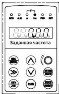
Рис. б Режим ожидания, отображение параметров режима ожидания
